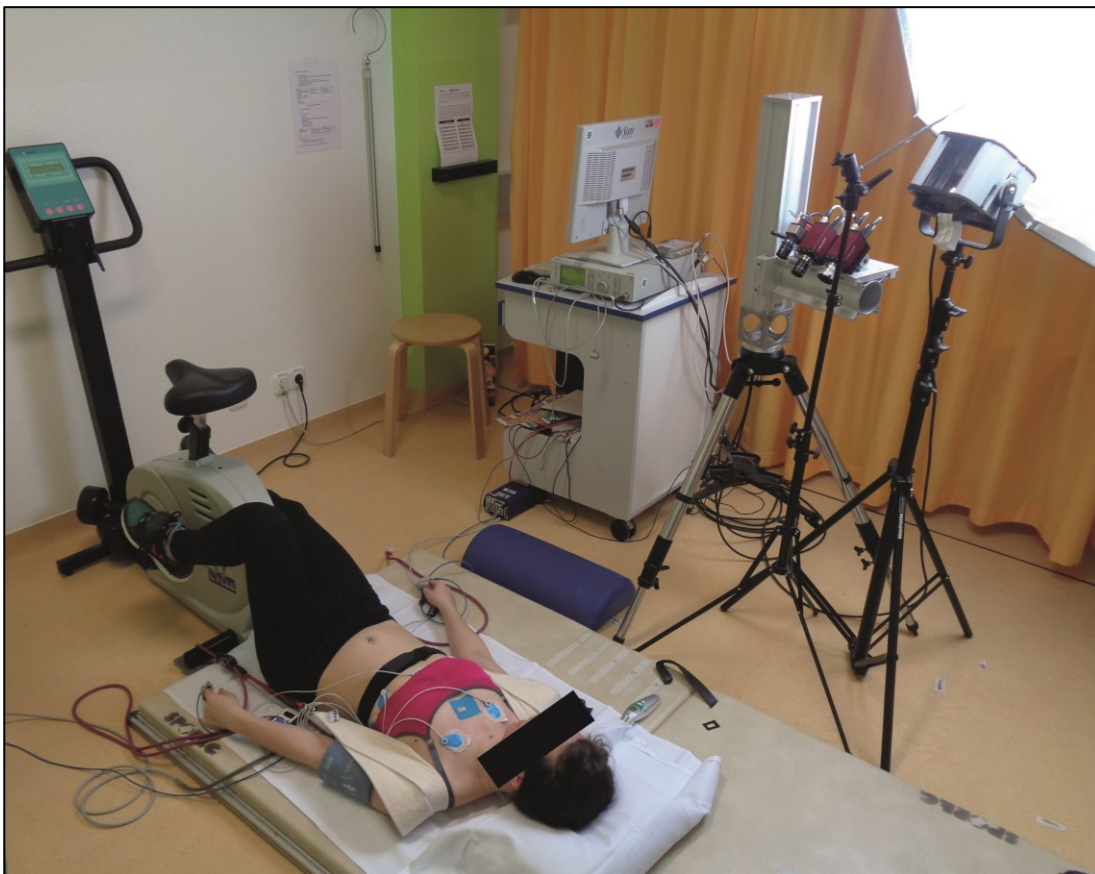
Abb. 1: Versuchsaufbau am Liegeergometer mit Anschluss aller Sensoren und Positionierung der Kameras (rechts im Bild)
