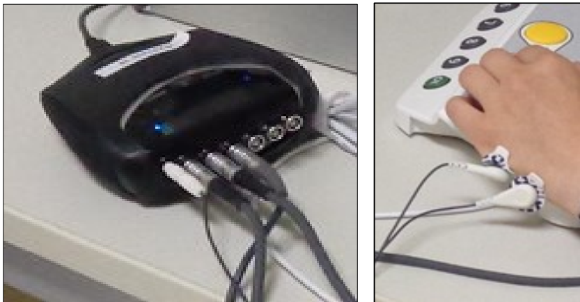
Abb. 2.: NeXus 10 Aufnahmegerät mit Sensoren (links); Sensoren-Platzierung für Hautleitwert (rechts)
