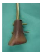
Fazit: Winkelstabile Verriegelungsbolzen erlauben eine höhere Anzahl an Lastwechseln bis zum Bruch
