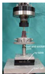
Fazit: Winkelstabile Verriegelungsbolzen erlauben eine höhere Anzahl an Lastwechseln bis zum Bruch
